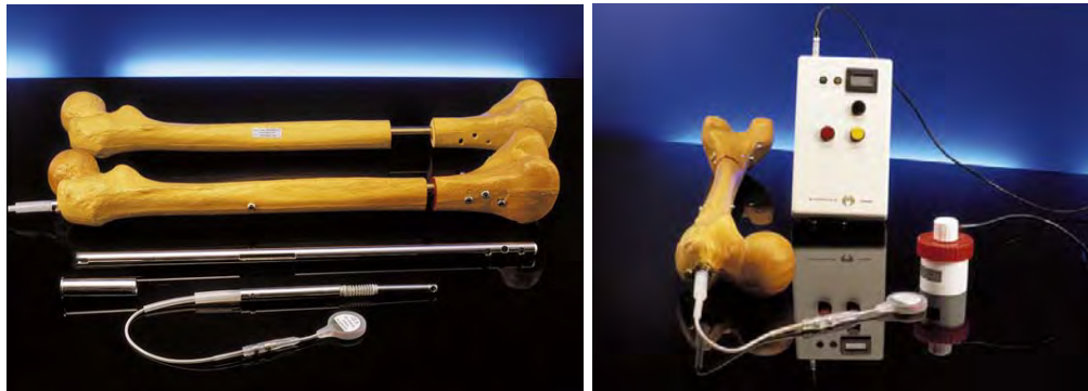
Abbildung 5: Voll implantierbares, mechatronisches System zur Knochenverlängerung
